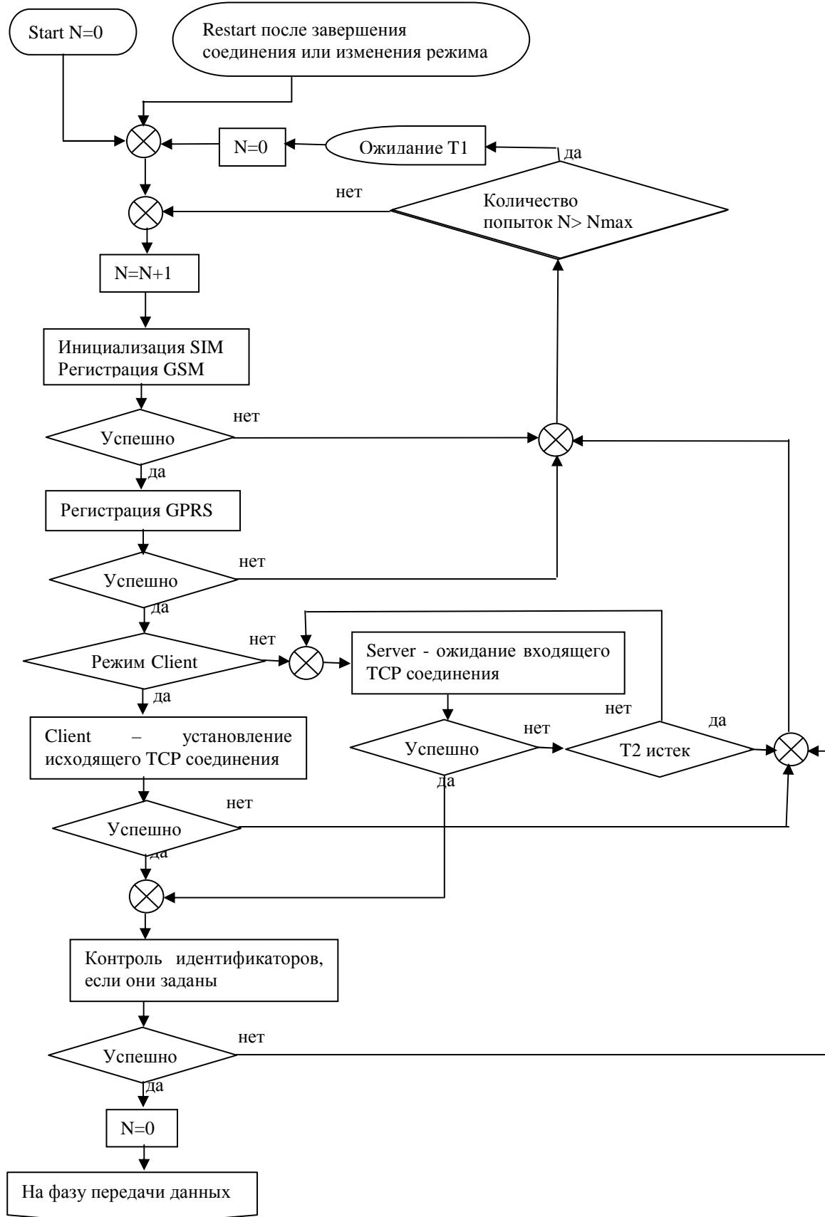
2.3.6 Блок схема фазы установления соединения для режима CSD (без алгоритма перехода на резервную SIM карту). Установка параметров:
