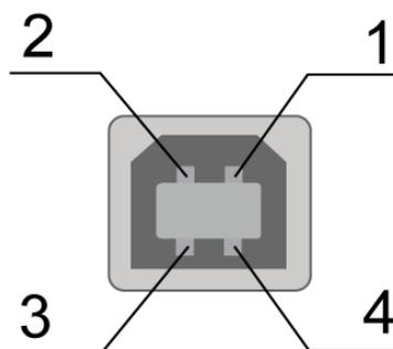
Рис. 2.5.3 Разъём USB
